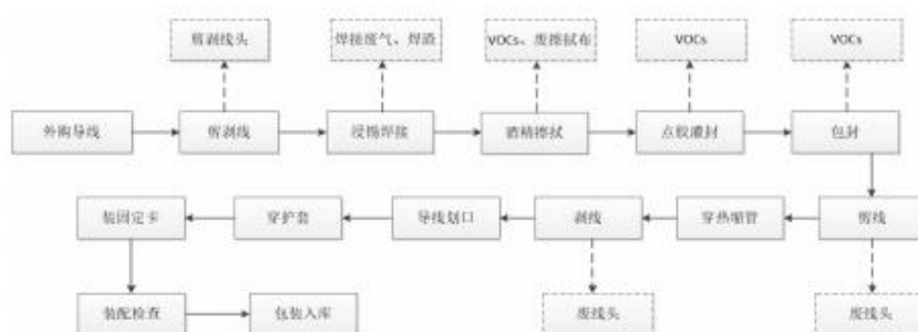
图1 蒸发器温度传感器工艺流程及产污节点图
