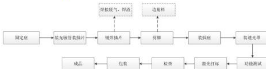
图1 蒸发器温度传感器工艺流程及产污节点图
