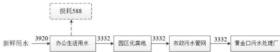
图 2-1 项目水平衡图（单位：m 3 /a）
