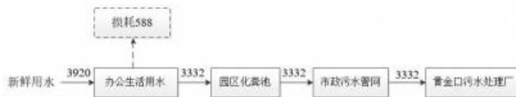
图6 项目水平衡图（单位：m³/a）
